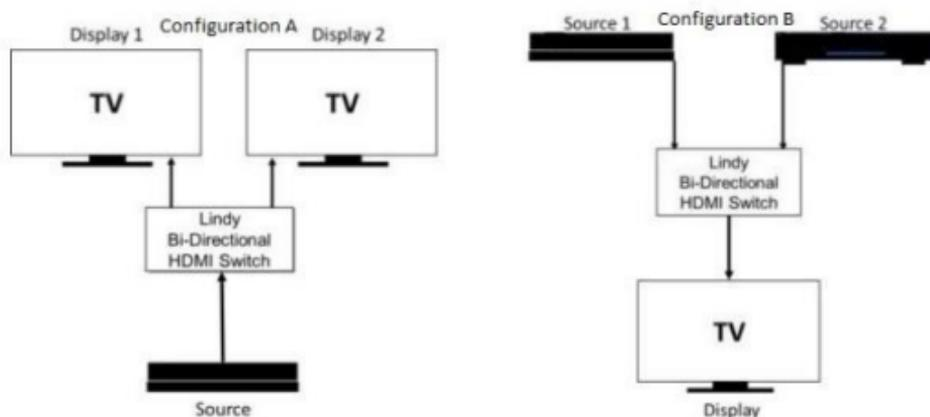
La configuration A montre un appareil source et deux écrans connectés au commutateur. Le commutateur permet alors à l'utilisateur d'alterner facilement la sortie entre l'écran 1 et l'écran 2.
